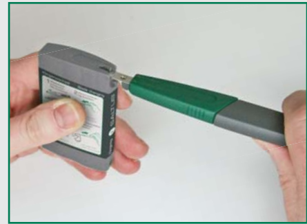
Berührungsloser Klingenswechsel durch SALTUS® S1 Messer-Magazin-Systemlösung Contact-free blade changes using the SALTUS® S1 cutter blade magazine system
